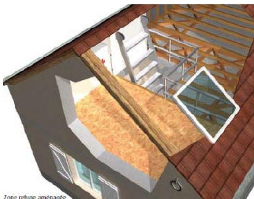
Figure 7 : principe d'une zone refuge à minima.
