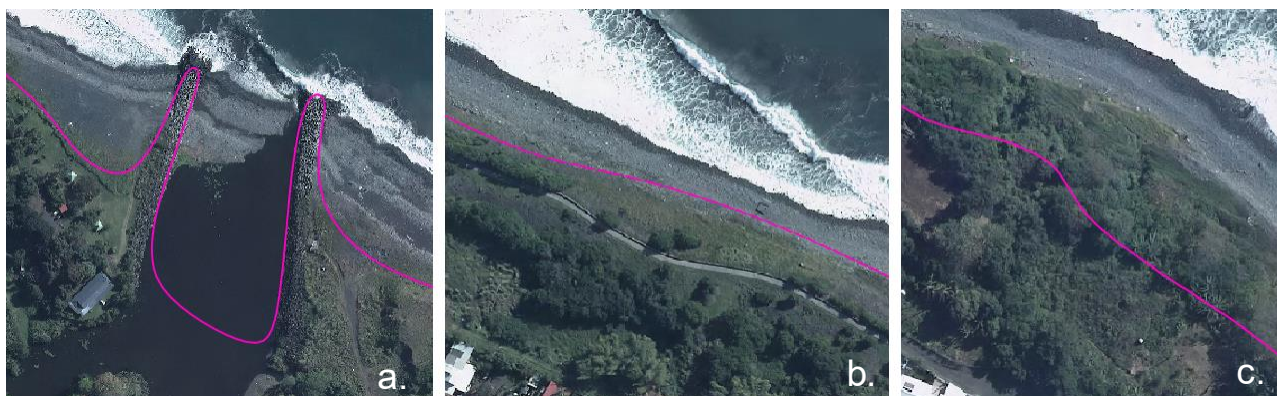
Figure 31 – Exemple de définition du trait de côte suivant les morphotypes du littoral de la côte nord-est: a. limite en pied d'aménagement (ortho 2011); b. limite de végétation (ortho 2011); c. limite de haut de versant (lidar)
