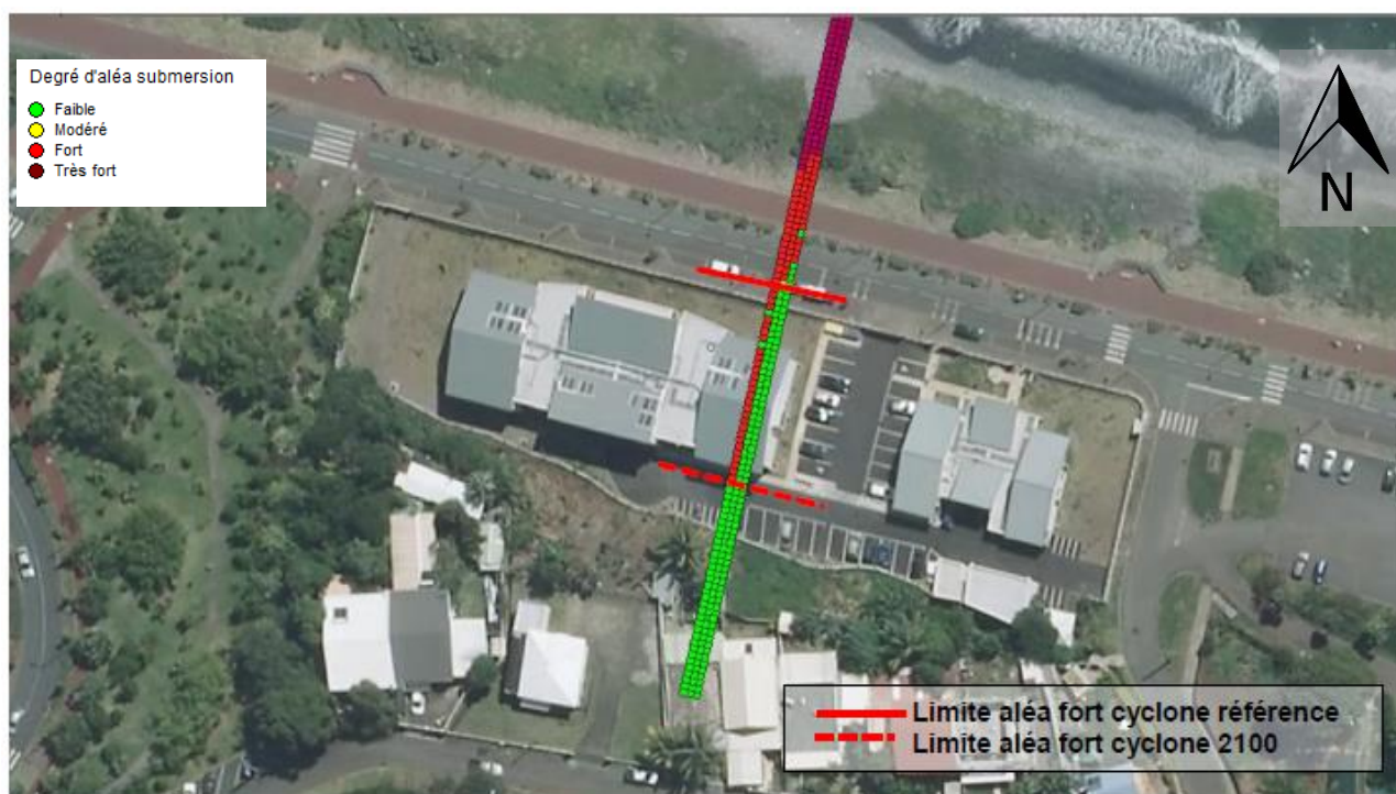
Figure 48 - Evènement de référence « cyclone Dina » : Limites de l'aléa fort le long du profil 2.1 pour les scénarios « référence » et « 2100 » pour 1 heure simulée –Vue en plan (Fond orthophotographie 2011, IGN©))
