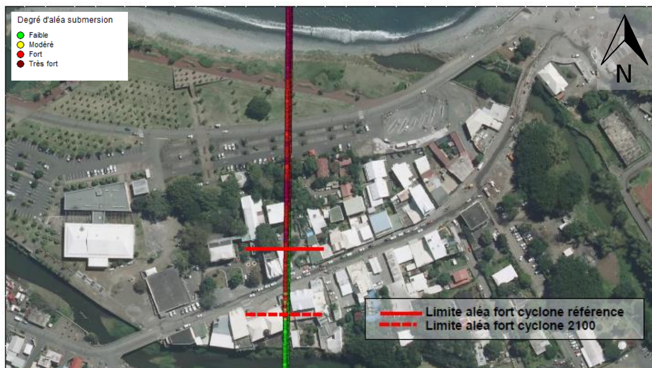
Figure 50 : Evènement de référence « cyclone Dina » : Limites de l'aléa fort le long du profil 2.2 pour les scénarios « référence » et « 2100 » pour 1 heure simulée – Vue en plan (Fond orthophotographie 2011, IGN©))
