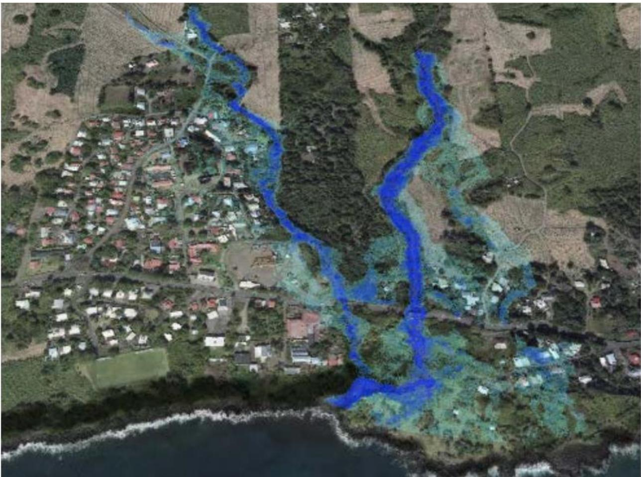
Figure 25 : Illustration 3D des écoulements d'une crue centennale, secteur de La Ravine Glissante. HYDRETUDES, 2021.
