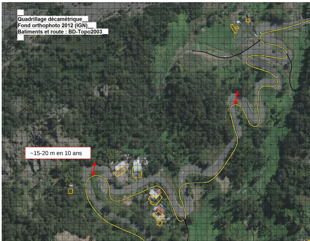
Figure 18 : Illustration de l'impact du glissement de Mare à Poule d'Eau sur les terrains – déplacement dans le temps de plusieurs mètres
