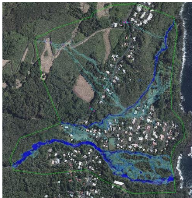
T = 30min : Décrue des affluents mais pic de crue de la Ravine Constantin. Les débordements en rive droite se multiplient : en amont de l'OH2 vers la Ravine Bois Blanc, en aval de l'OH2 et à la confluence avec l'affluent 2. Ce dernier inonde une partie des habitations du quartier en aval.
