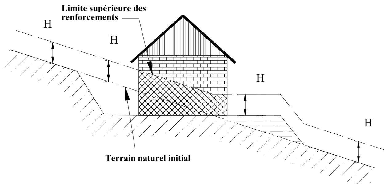
Toute disposition architecturale particulière ne s'inscrivant pas dans ce schéma de principe, devra être traitée dans le sens de la plus grande sécurité.
