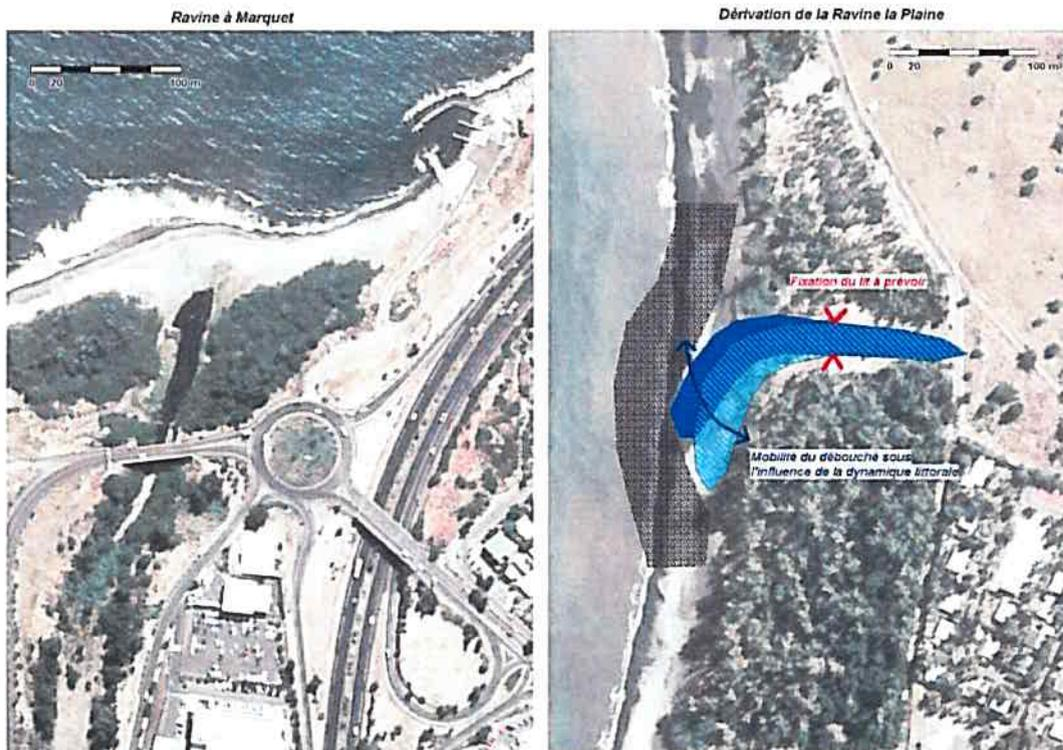
Afin de fixer la mobilité du lit dans des limites acceptables à proximité du débouché, il est proposé la réalisation d'un point dur environ une centaine de mètres en amont du littoral (épis en enrochements, culées d'un ouvrage de franchissement, passerelle piétonne par exemple). Ce positionnement permet d'être le plus proche possible du littoral en évitant toutefois un contournement de ce point dur en amont.
