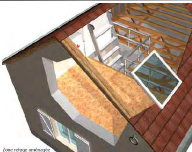
Figure 19 : principe d'une zone refuge à minima.
