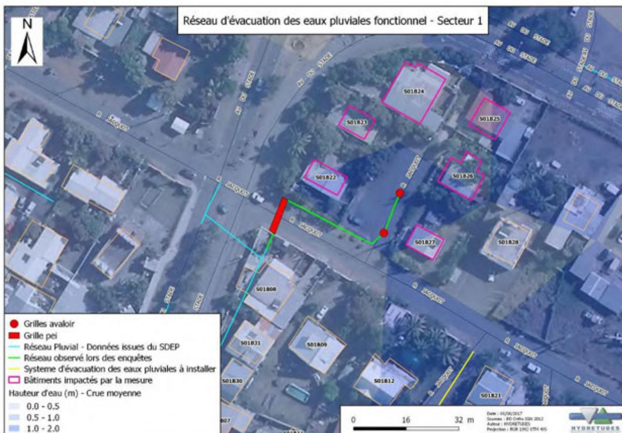
Figure 78: Système d'évacuation des eaux de pluie – MRP8
