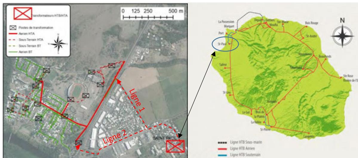
Figure 42 : Position du transformateur HTB/HTA (haute 63kV/Moyenne tension) le plus proche du quartier Jacquot
