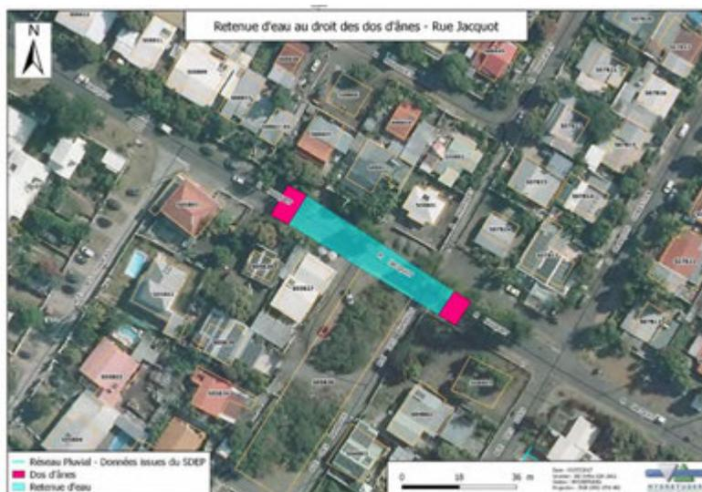
Figure 66: Retenue d'eau exercée par les dos d'âne de la rue Jacquot
