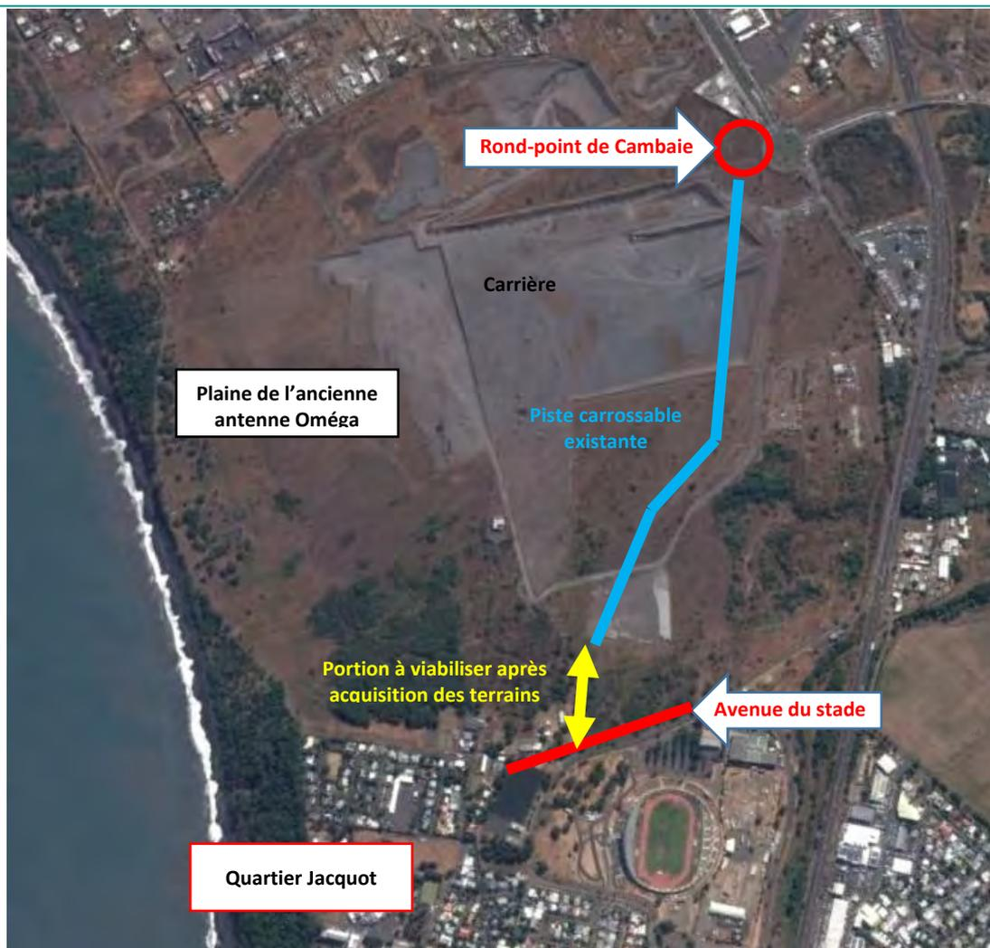
Figure 83 : MG1.5 – Création d'une déviation provisoire mais sécuritaire travers la plaine Oméga et ouverture exceptionnelle pour la gestion de crise
