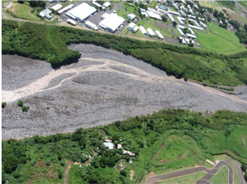
*Photo n°2 – EPIS MARTEAUX EN RIVE DROITE DE LA RIVIERE DES PLUIES*
