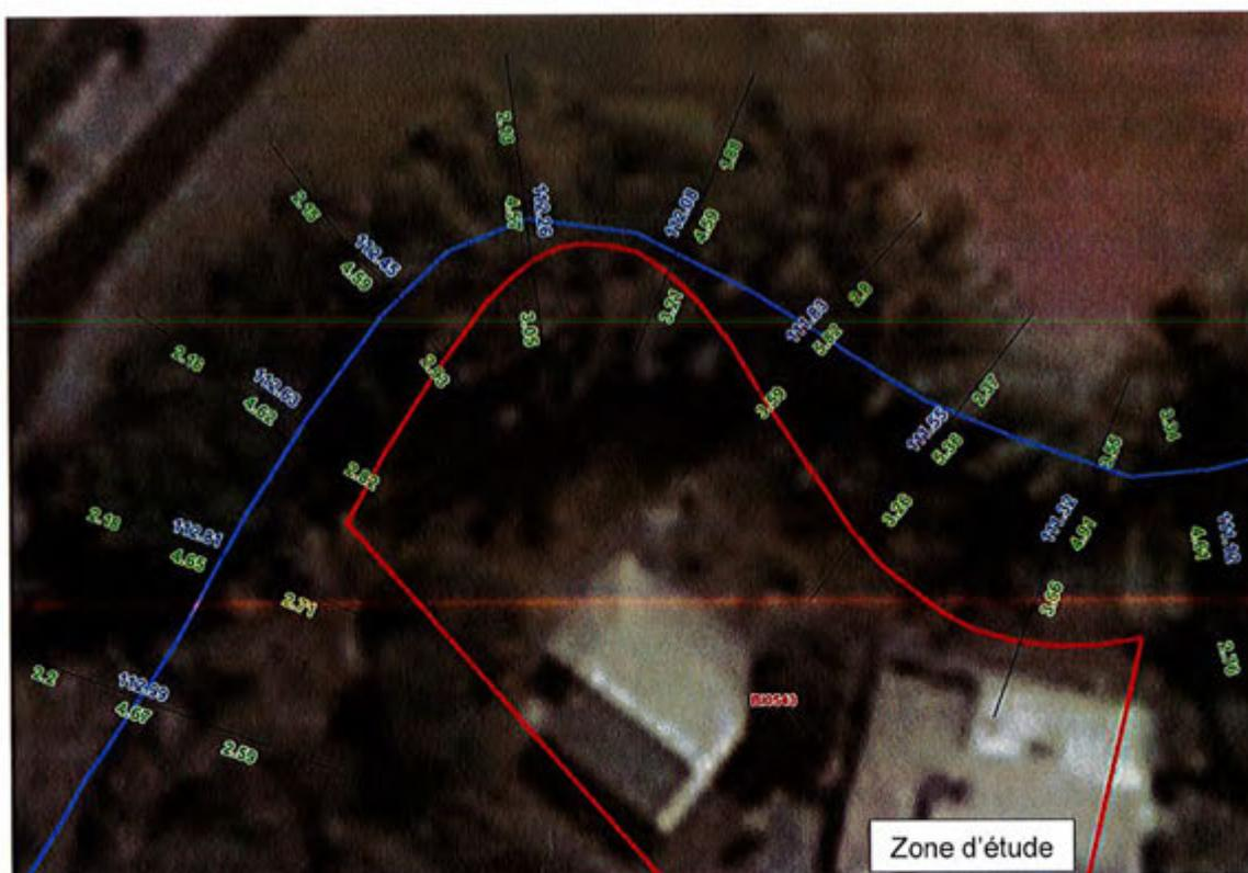
**Fig. 23. Cartographie des niveaux de crue et vitesse d'écoulement pour une crue type Fakir (en mNGR et m/s)**
