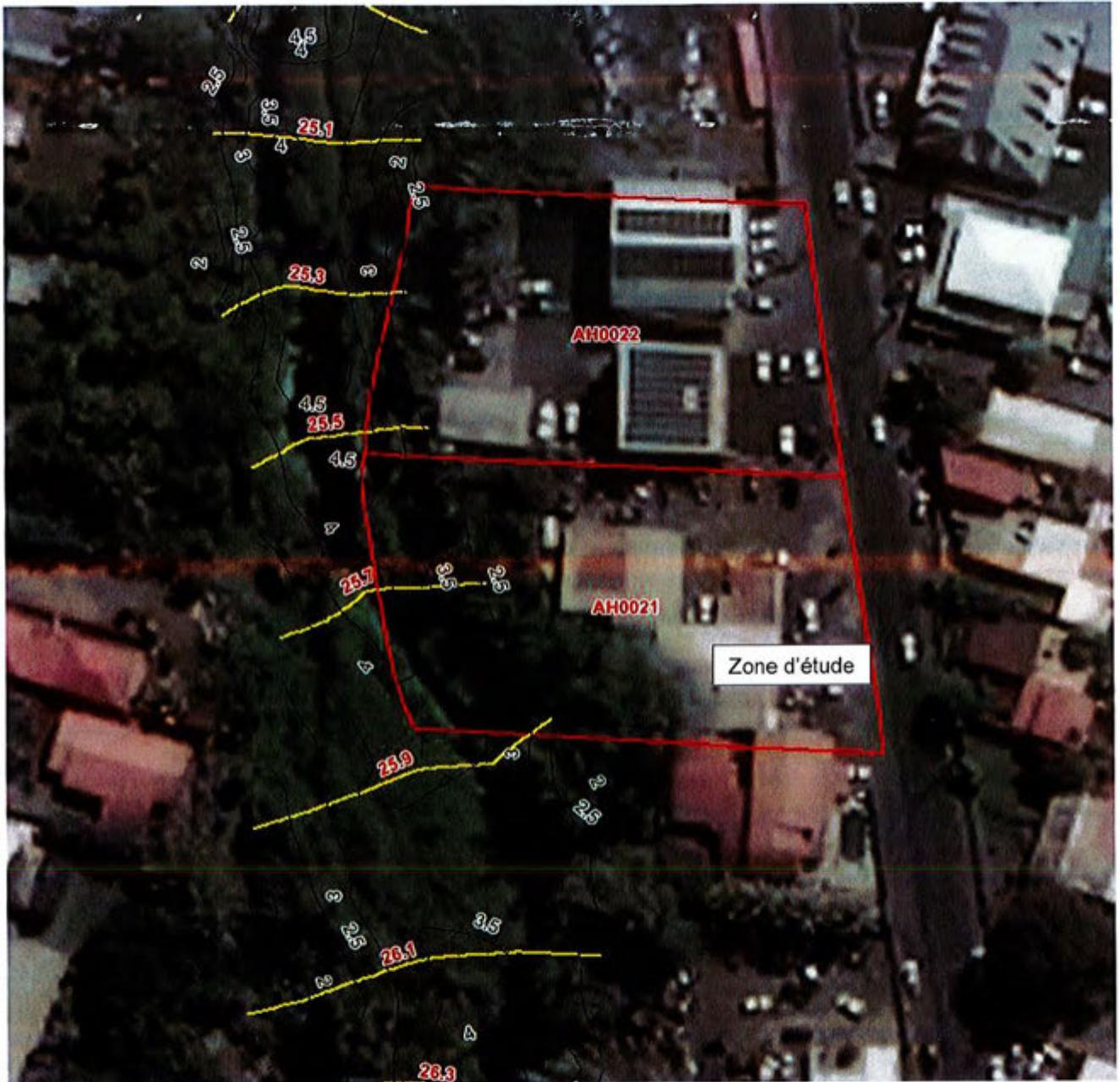
**Fig. 32. Cartographie des niveaux de crue et vitesse d'écoulement pour une crue type Fakir (en mNGR et m/s)**
