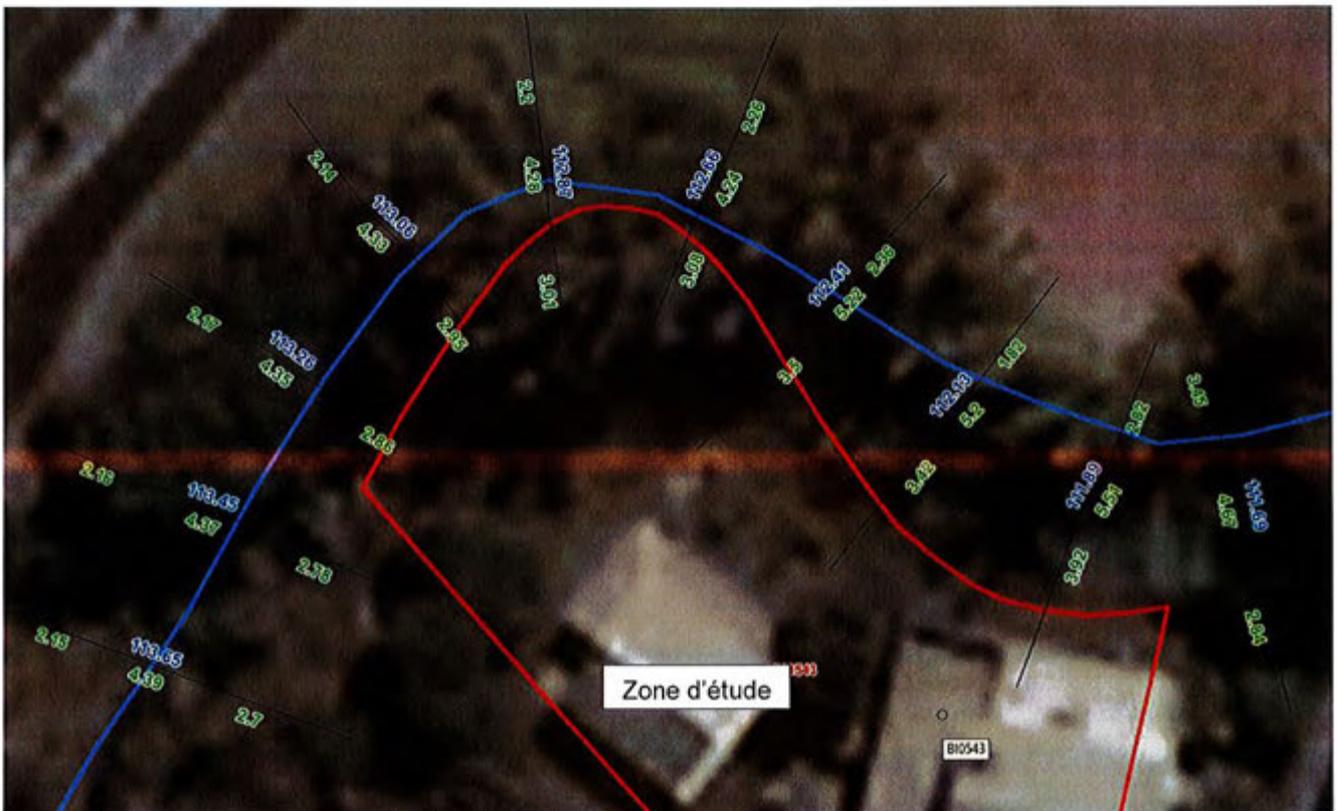
L'analyse de la cartographie des vitesses confirme l'augmentation des vitesses à l'extrados ainsi que les vitesses au droit de la zone de projet.
