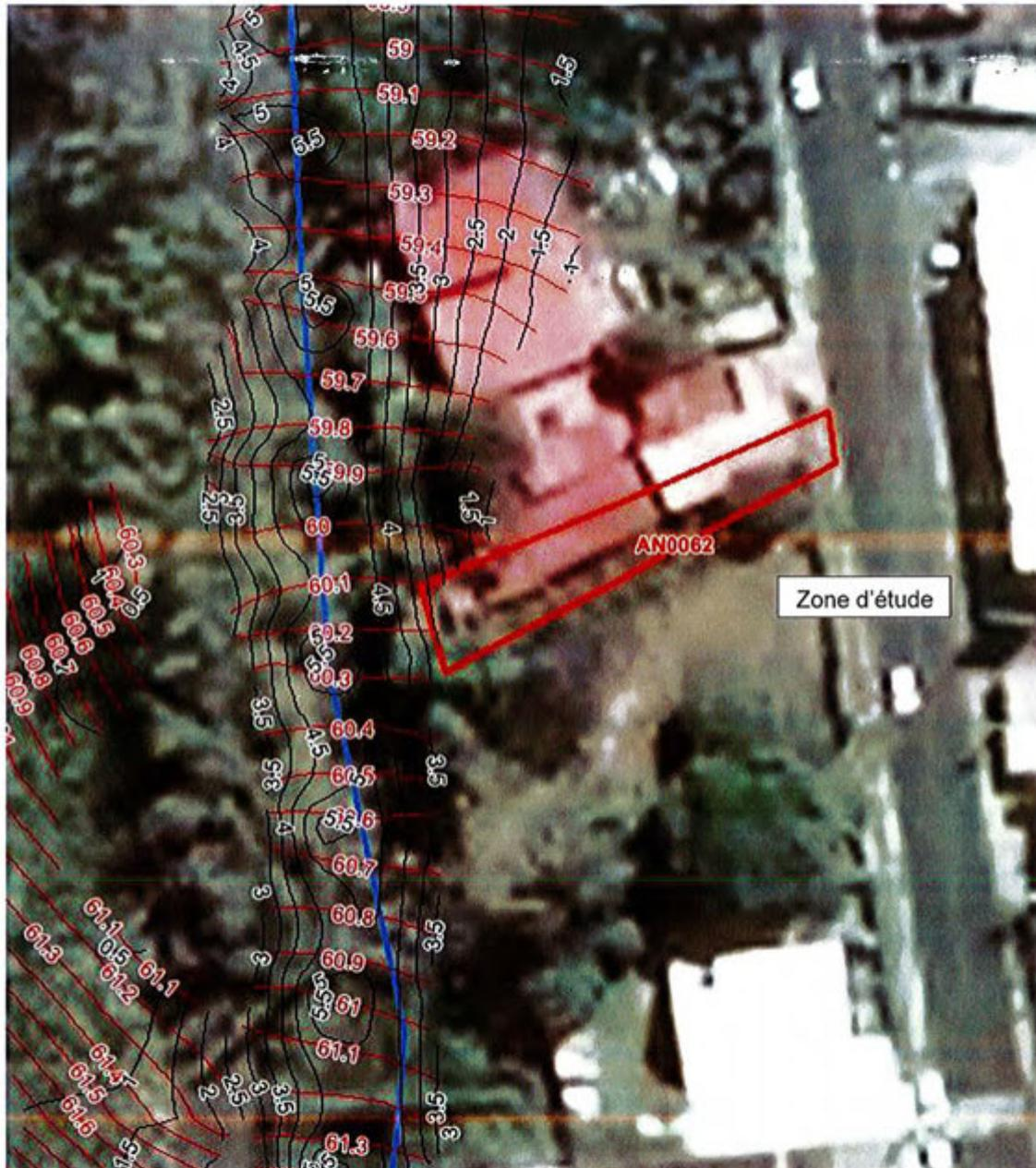
**Fig. 27. Cartographie des niveaux de crue, des hauteurs d'eau et de la vitesse d'écoulement pour une crue centennale (en mNGR et m/s)**
