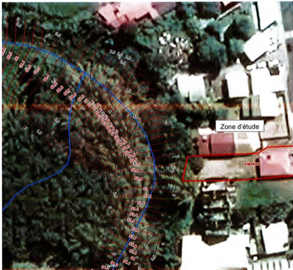
**Fig. 29. Cartographie des niveaux de crue, des hauteurs d'eau et de la vitesse d'écoulement pour une crue centennale (en mNGR et m/s)**
