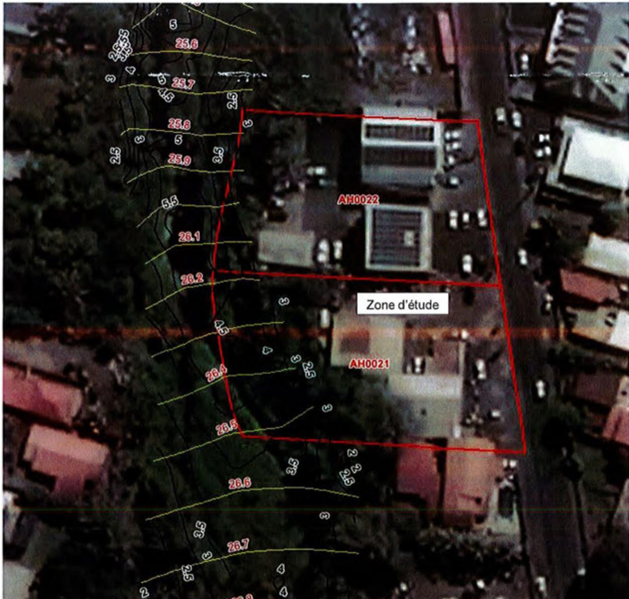
**Fig. 33. Cartographie des niveaux de crue et vitesse d'écoulement pour une crue type Fakir (en mNGR et m/s)**
