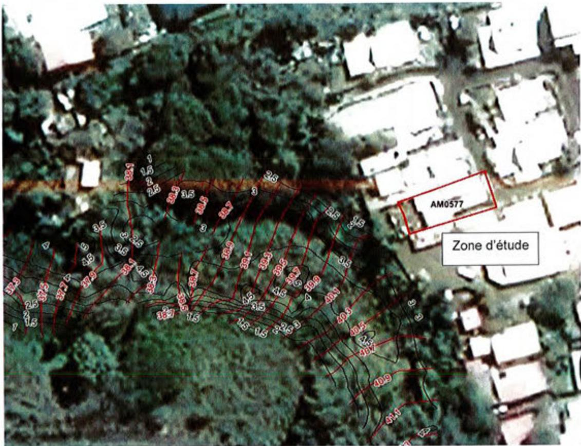
**Fig. 30. Cartographie des niveaux de crue des hauteurs d'eau et de la vitesse d'écoulement pour une crue type Fakir (en mNGR et m/s)**
