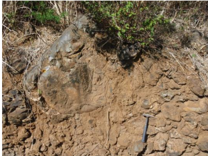
Fig. 9. ALLUVIONS ANCIENNES CIMENTEES ET ALTEREES, JAUNE OCRE, EN RIVE GAUCHE, EN AVAL DU PONT DU BOULEVARD SUD
