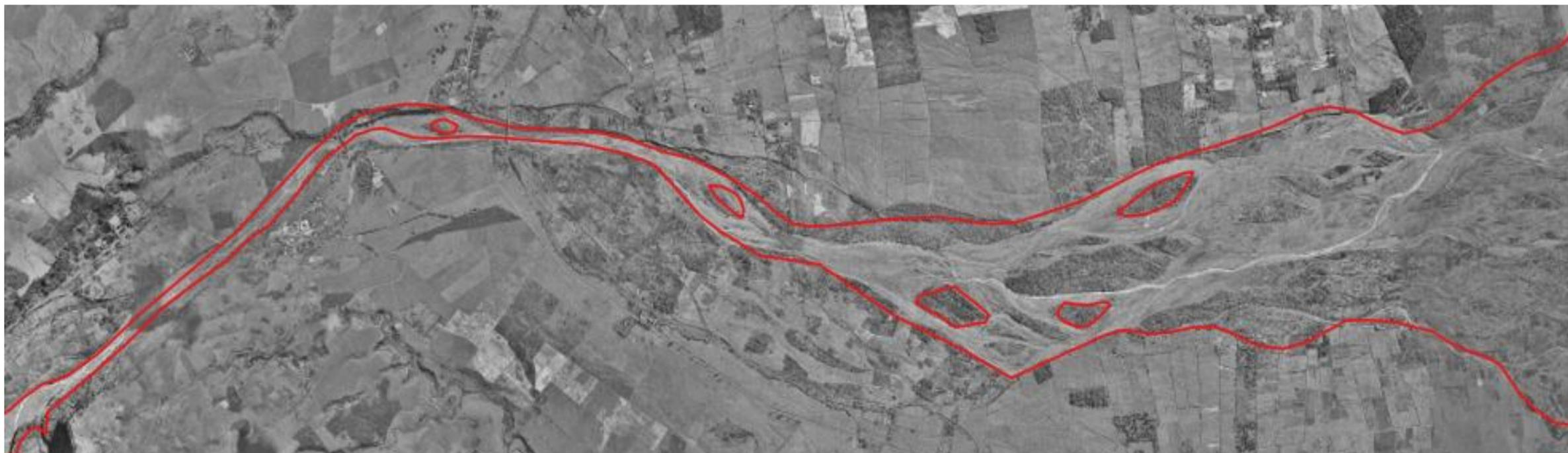
*Illustration 25: Comparaison des limites des alluvions Fz de la carte géologique avec le lit actif du tronçon aval du lit de la Rivière du Mât en 1950*
