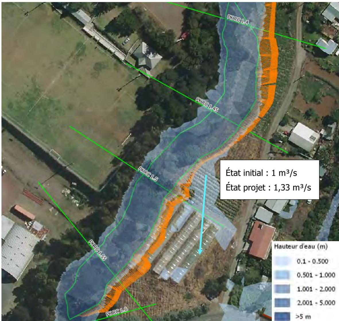
Figure 138 : Extrait des résultats de la modélisation projet –  $Q_{30}$  en amont de la route du Géranium
