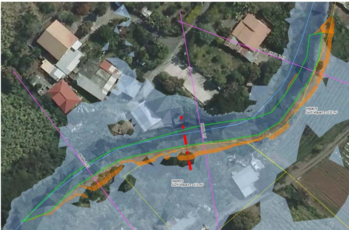
Figure 79 : Implantation de l'élargissement du lit en rive gauche – aménagement n°BA16
