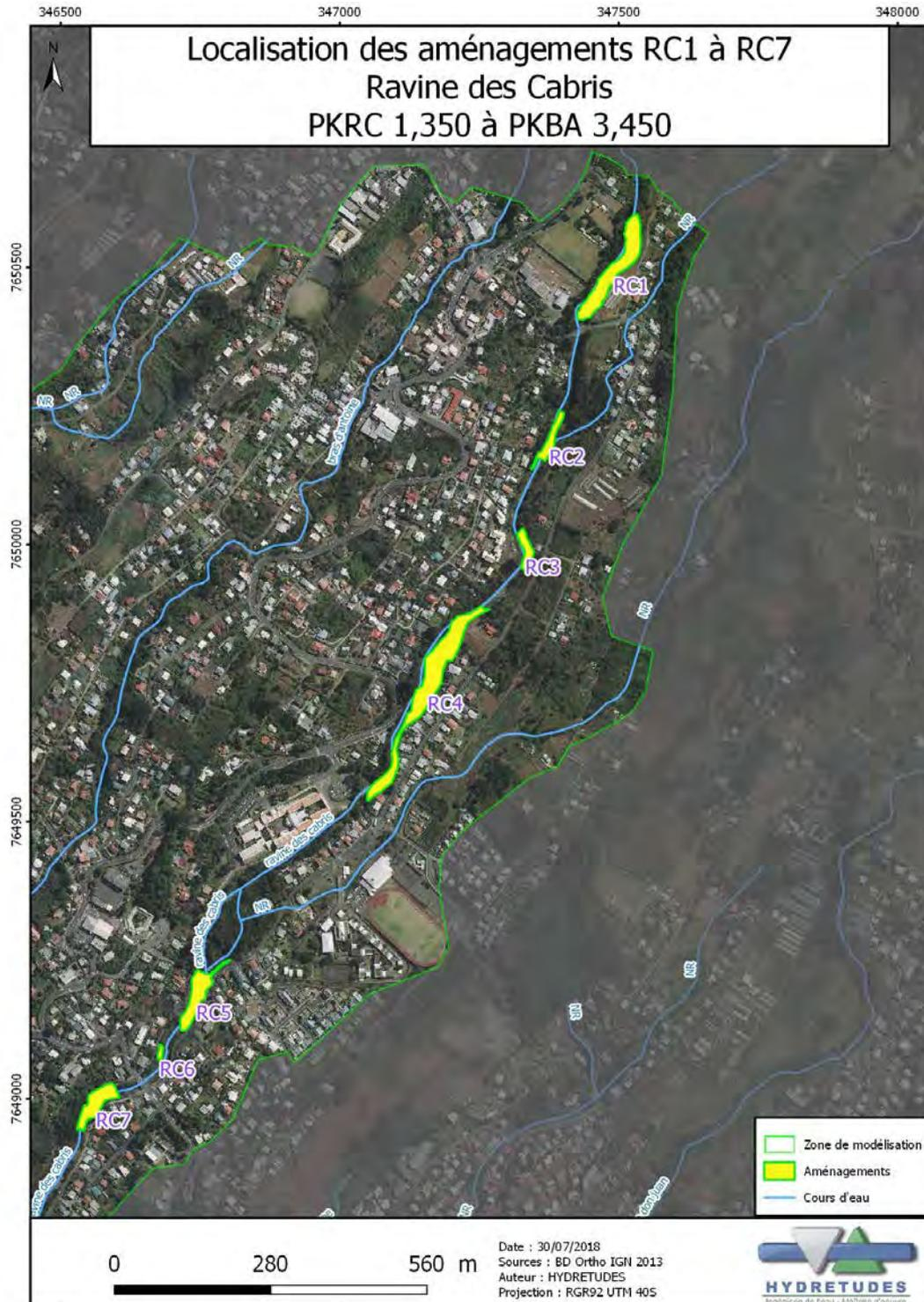
Figure 82 : Localisation des aménagements proposés sur la ravine des Cabris du PK RC 1,350 au PK RC 3,450
