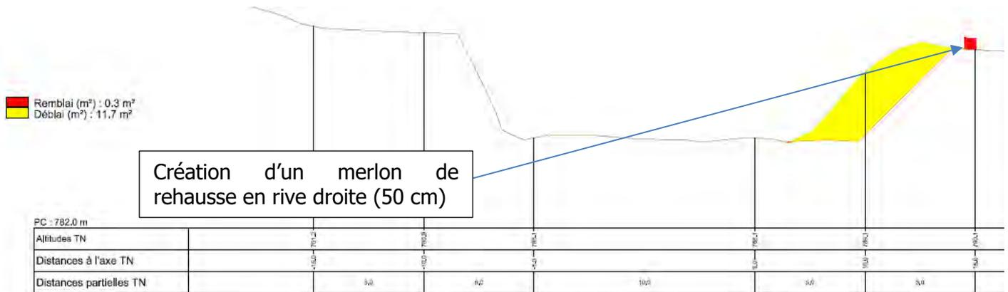
Figure 104 : Profil type de l'aménagement n°RC6
