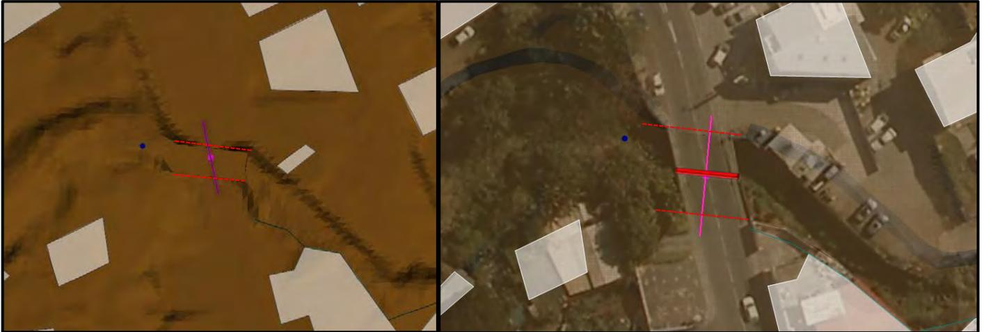
Figure 52 : Vue de dessus sur la configuration des berges au droit du pont RD3 à l'état initial (à gauche) et à l'état projeté (à droite)
