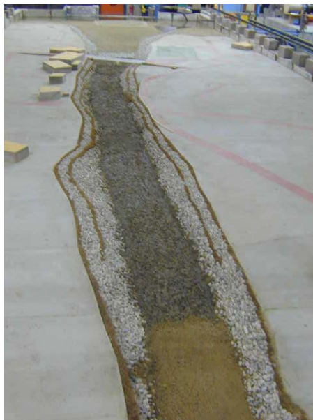
Mise en place du fond fixe entre les 2 ponts
