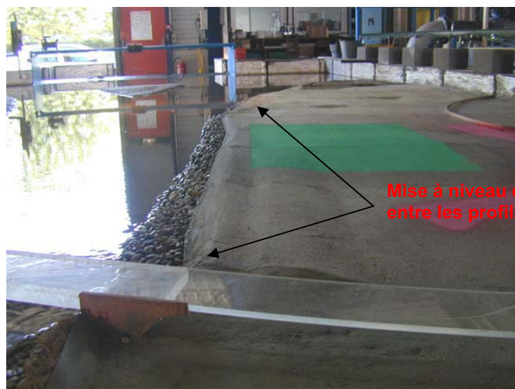
Cotes de la berge en RD requises pour protéger le secteur du Ludoparc contre une crue vingtennale
