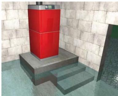
Protection d'un équipement de chauffage par surélévation.
