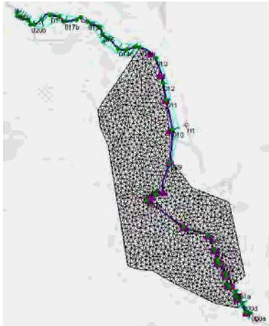
L'espace est discrétisé sous forme d'un maillage non structuré. Le module 2D d'InfoWorks est basé sur un maillage de surface, donnant un maximum de flexibilité pour le modéleur et en veillant à ce que le système soit inspiré de la topographie du site d'étude de façon aussi précise que possible.
