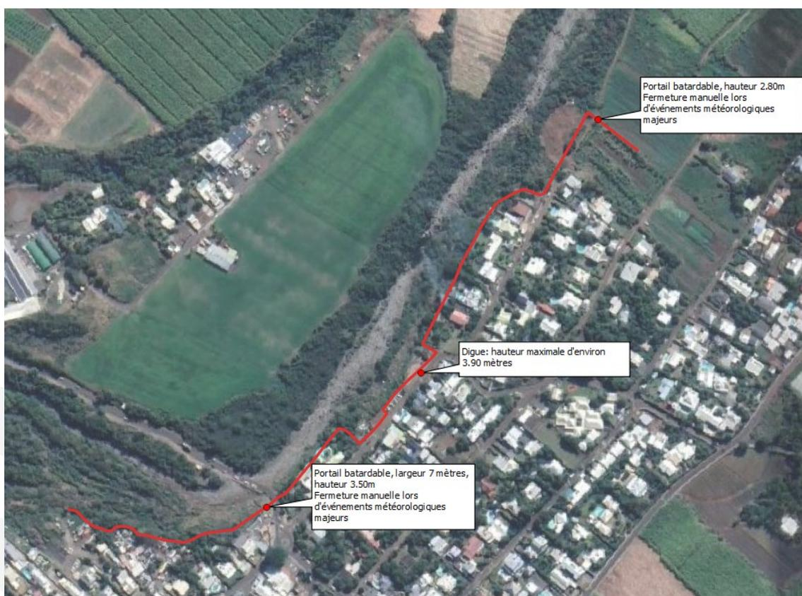
Figure 33 : Localisation de la digue de protection et des sections à portail batardable
