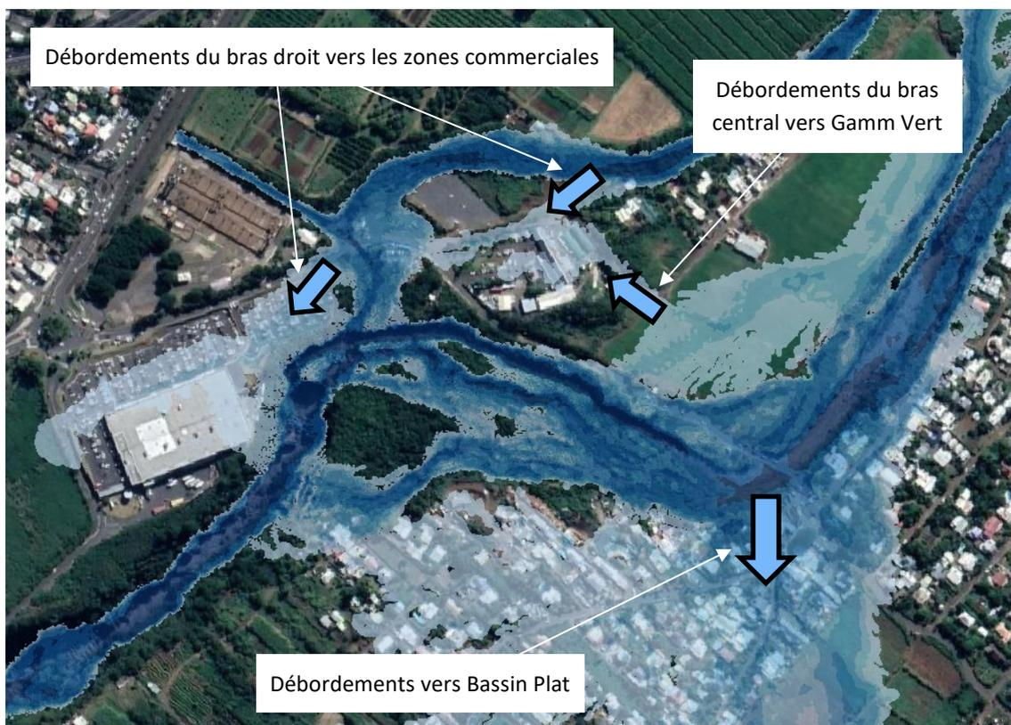
Figure 4 : Détail des écoulements (hauteur d'eau) en crue de référence (débit de dimensionnement)
