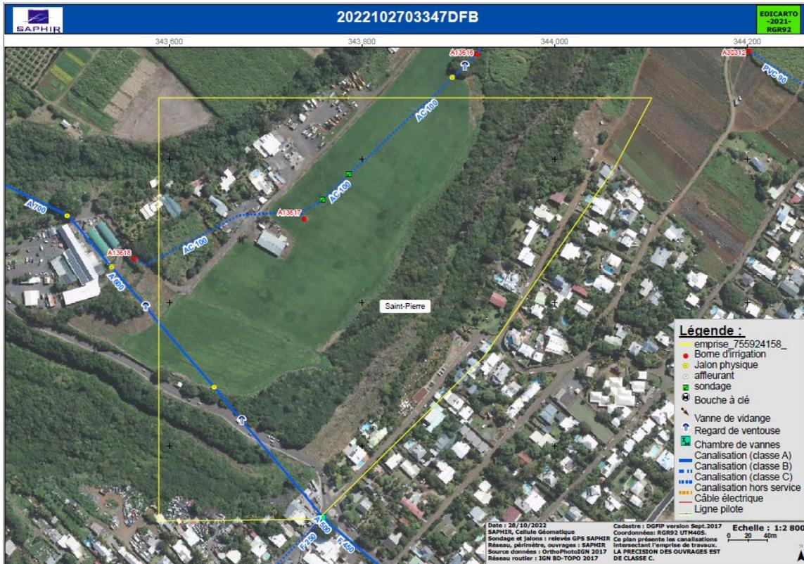
Figure 10 : Plan de réseau transmis par SAPHIR – DT n°2022102703347DFB
