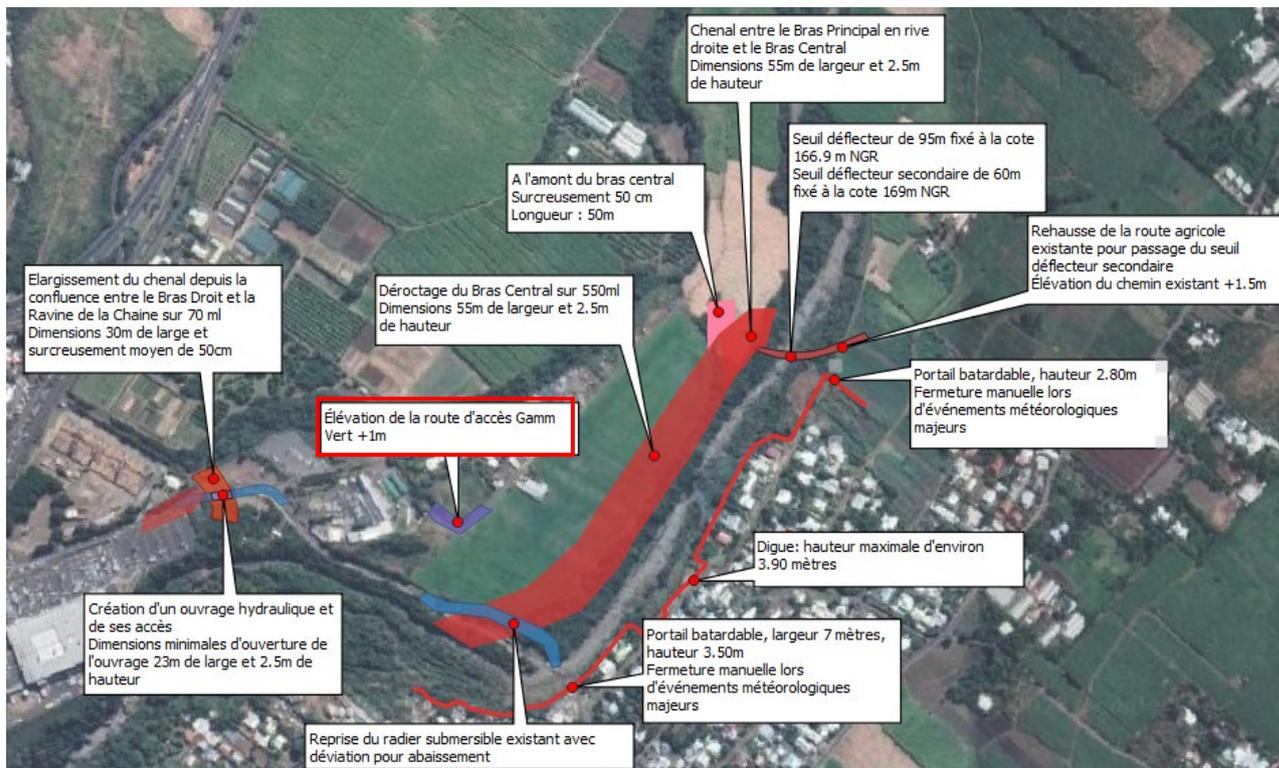
La réhausse sera effective sur 40ml en remontant vers le centre commercial et se raccordera avec une pente douce à l'altimétrie de la route existante.
