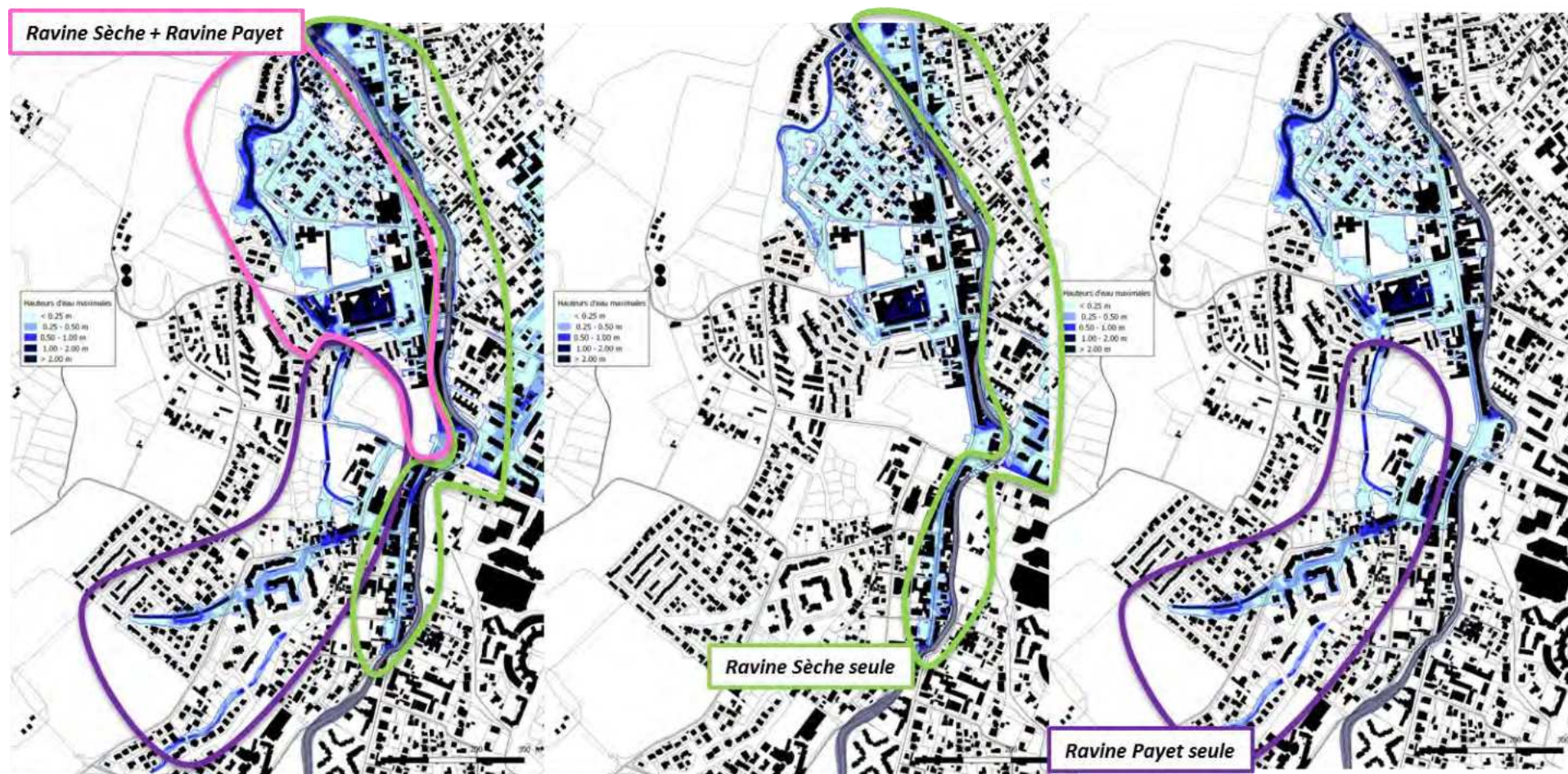
Fig. 19. Hauteurs d'eau maximales pour la crue centennale – Ravines Sèche et Payet à gauche, Ravine Sèche seule au centre, Ravine Payet seule à droite (résultats bruts de modélisation)
