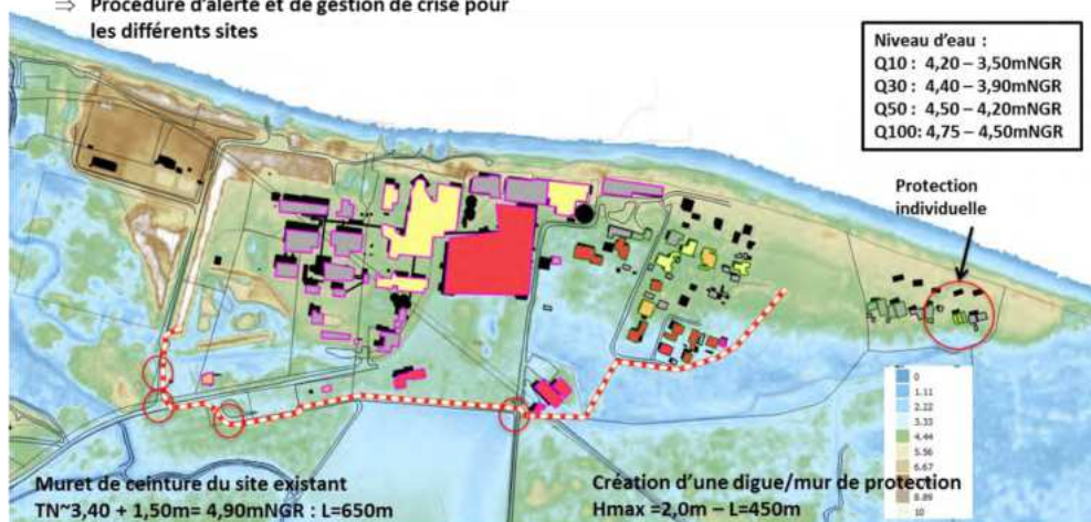
Fig. 114. Protections collectives du site de Bois Rouge
