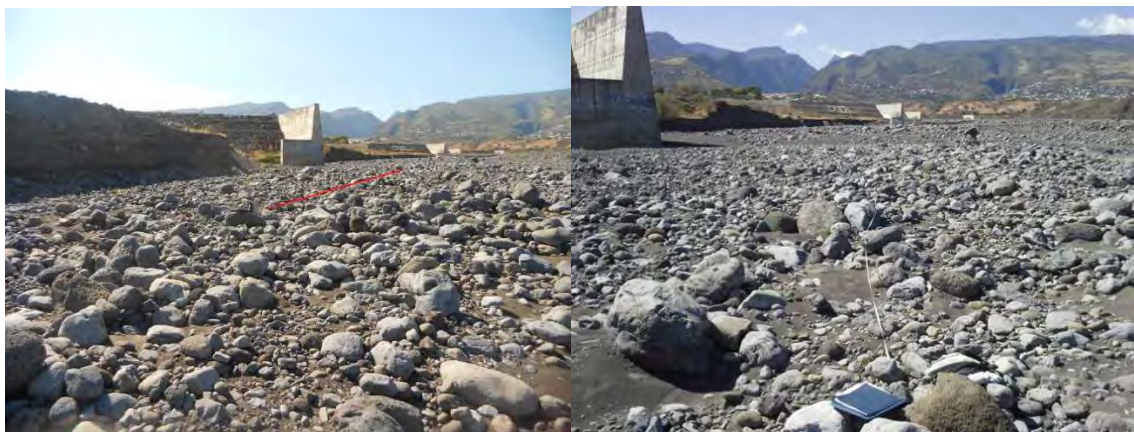
Figure 33 : Granulométrie réalisée par comptage de surface dans le lit de la Rivière des Galets - CNR
