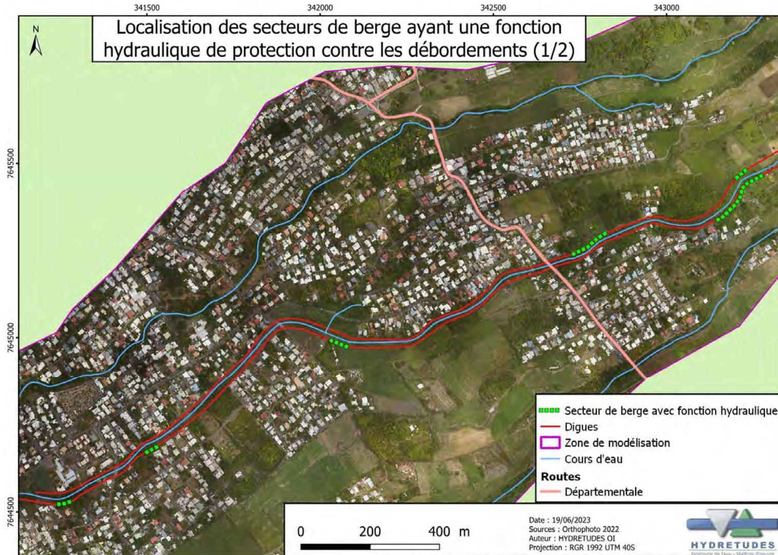
Figure 18 : Localisation des secteurs de berge ayant un rôle hydraulique de protection contre la crue centennale de la Ravine des Cabris (1/2)
