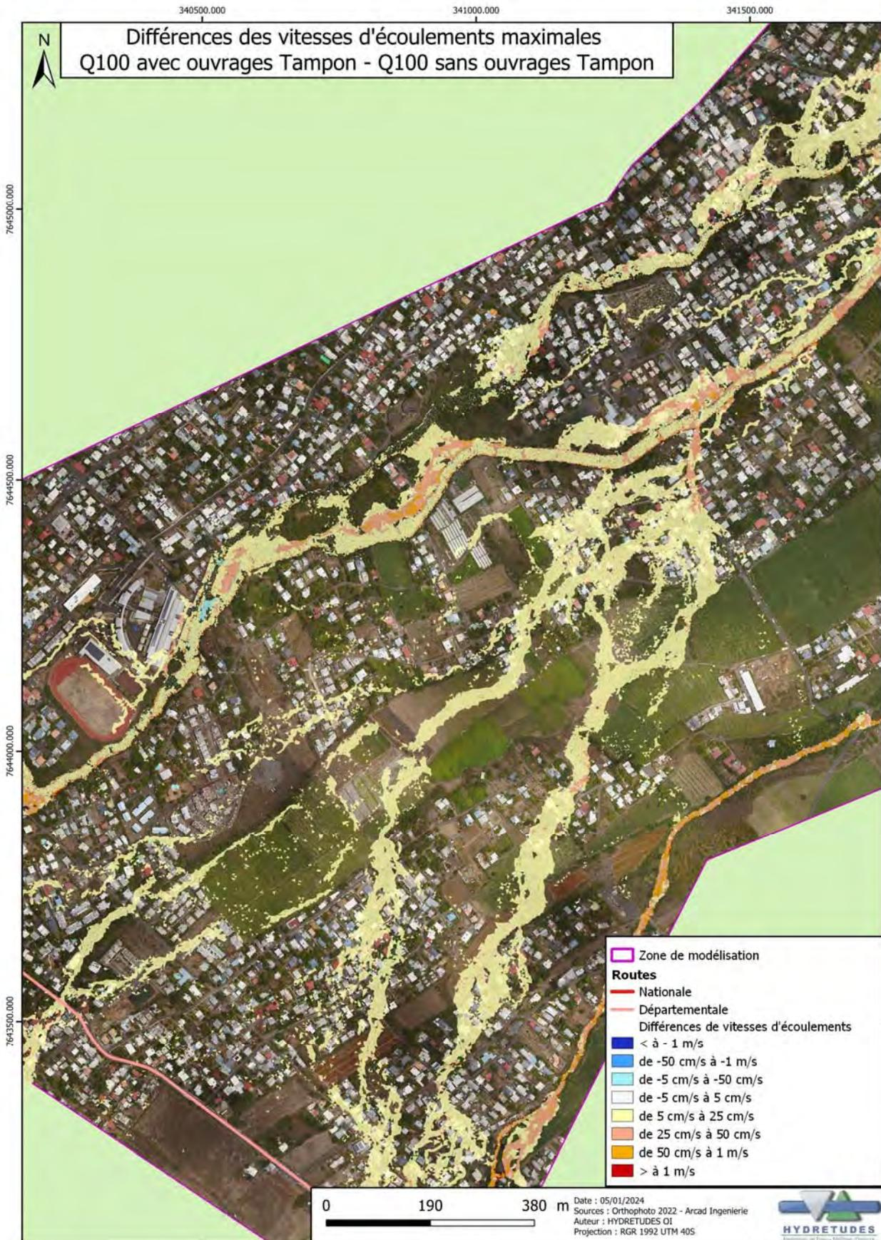
Figure 23 : Comparaison des valeurs de vitesses d'écoulement maximums avec et sans les aménagements réalisés sur la commune du Tampon : Q100 – carte n°3
