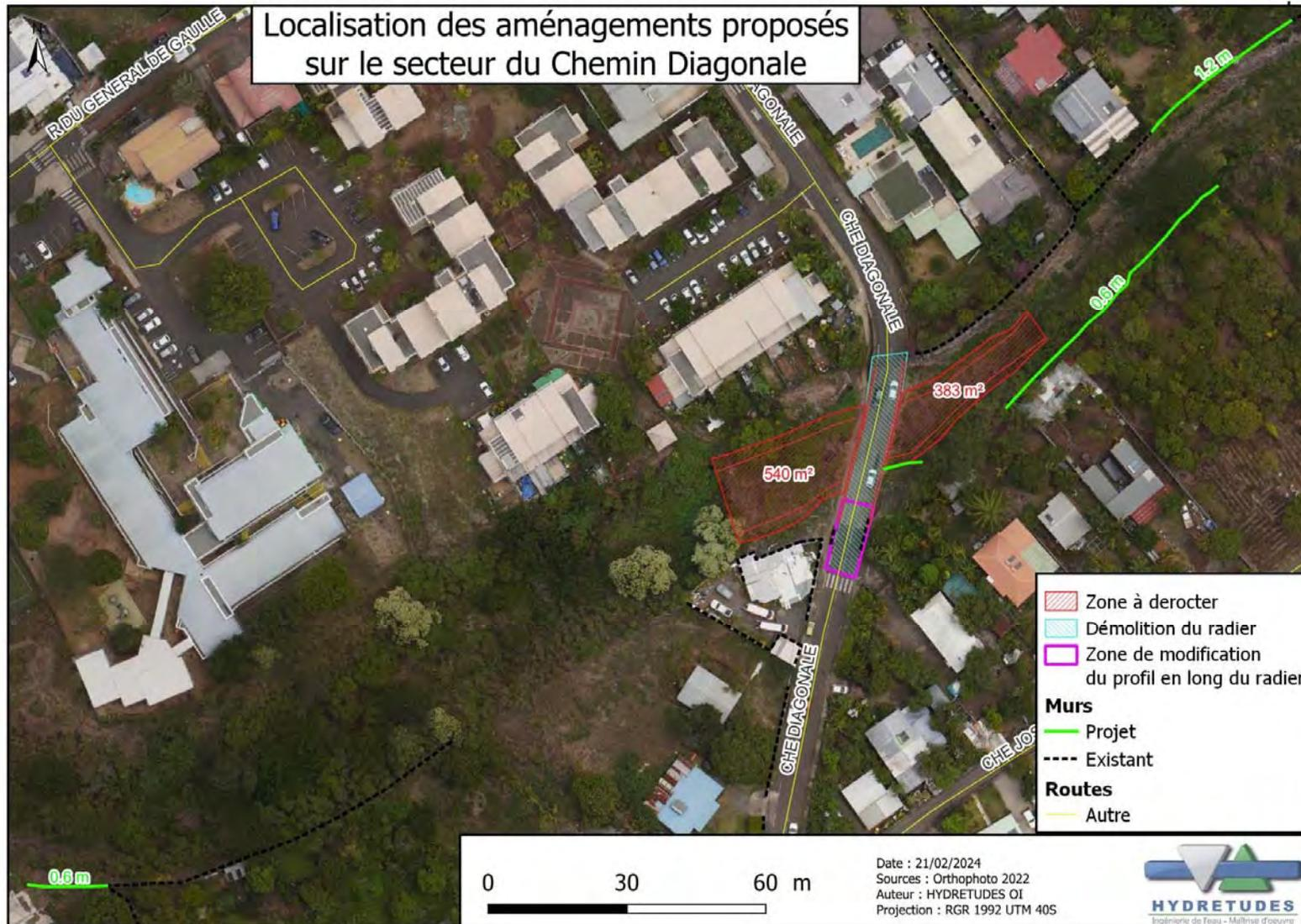
Figure 26 : Localisation des aménagements proposés pour supprimer les débordements dans le secteur du radier du chemin Diagonale
