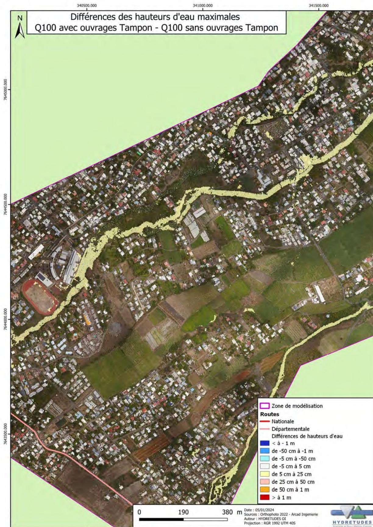
Figure 22 : Comparaison des valeurs de hauteurs d'eau maximum avec et sans les aménagements réalisés sur la commune du Tampon : Q100 – carte n°3
