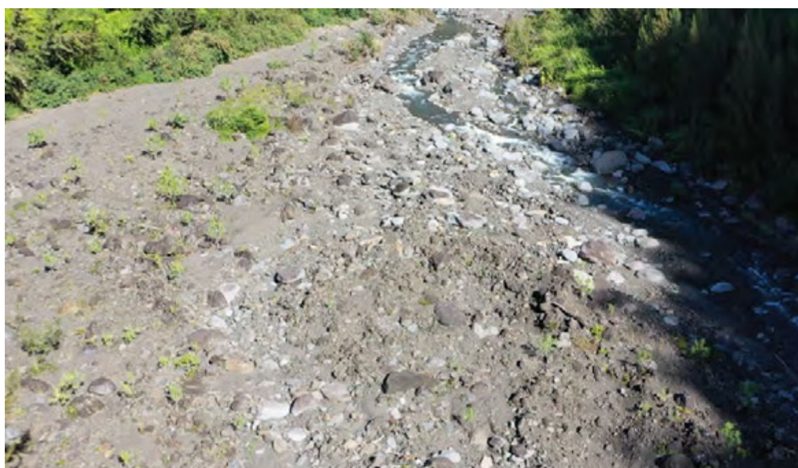
Figure 131 : Hétérogénéité de la granulométrie et possible début de pavage sur l'aval de RJ2 (vue drone – HYDETUDES 2022)
