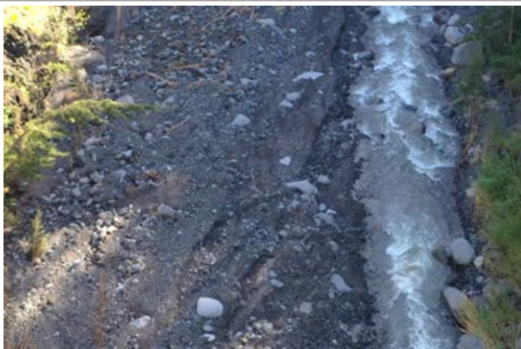
Figure 130 : Absence d'armure et granulométrie hétérogène sur FJ2 (vue drone – HYDETUDES 2022)
