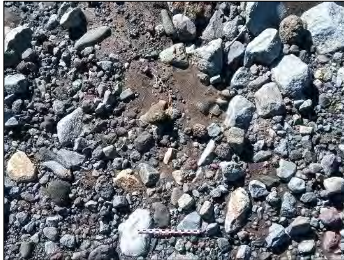
Figure 119 : Zoom sur la granulométrie en amont du seuil (mire 20 cm)
