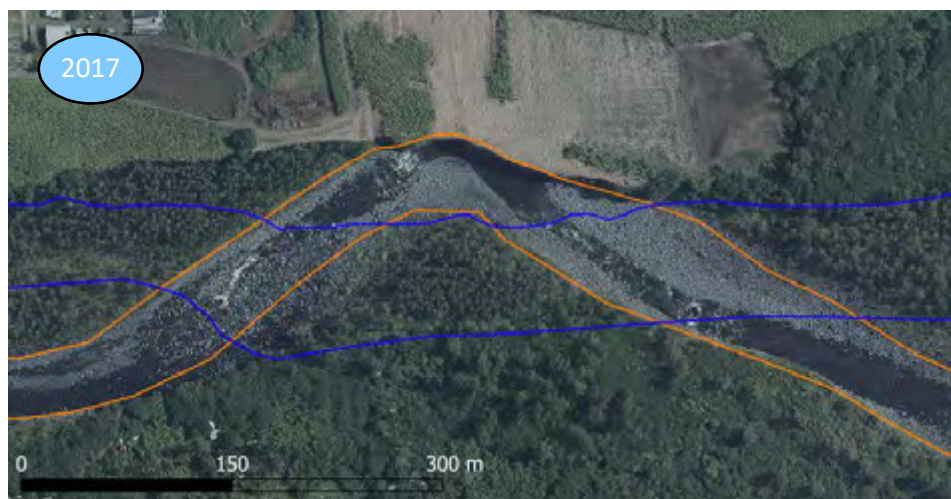
Figure 51 : Recul de 60 m de la rive gauche entre 1997 (bleu) et 2021 (orange)
