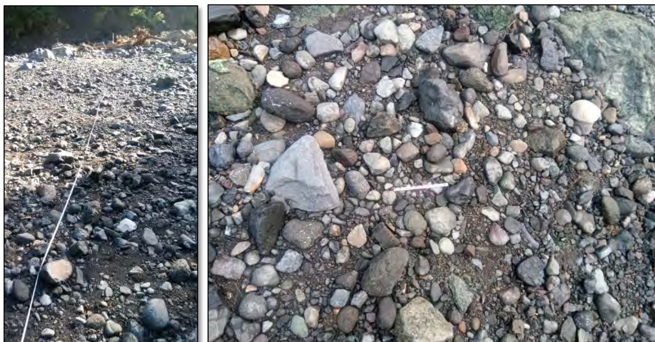
Figure 105 : Exemple d'un site de prélèvement : amont du tronçon M1 (à gauche décamètre matérialisant l'axe de prélèvement, à droite une photographie du substrat avec une mire de 20 cm)
