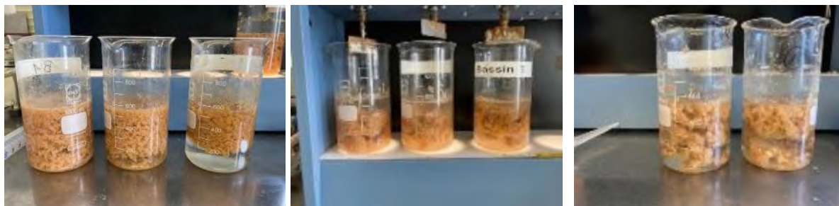
Campagnes de jar-tests : choix flocculant et conditions opératoires Divers essais de coagulants, flocculants, pH, conditions
