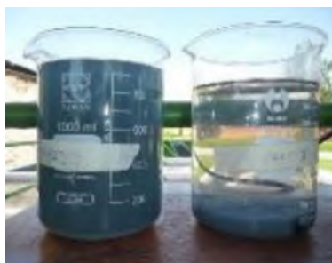
Campagne de jar tests : effluents textiles (coagulation/floculation)
