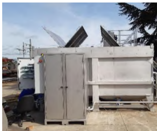
Installation tamis rotatif et flottateur 30 m 3 /h – Royal Bourbon industries
