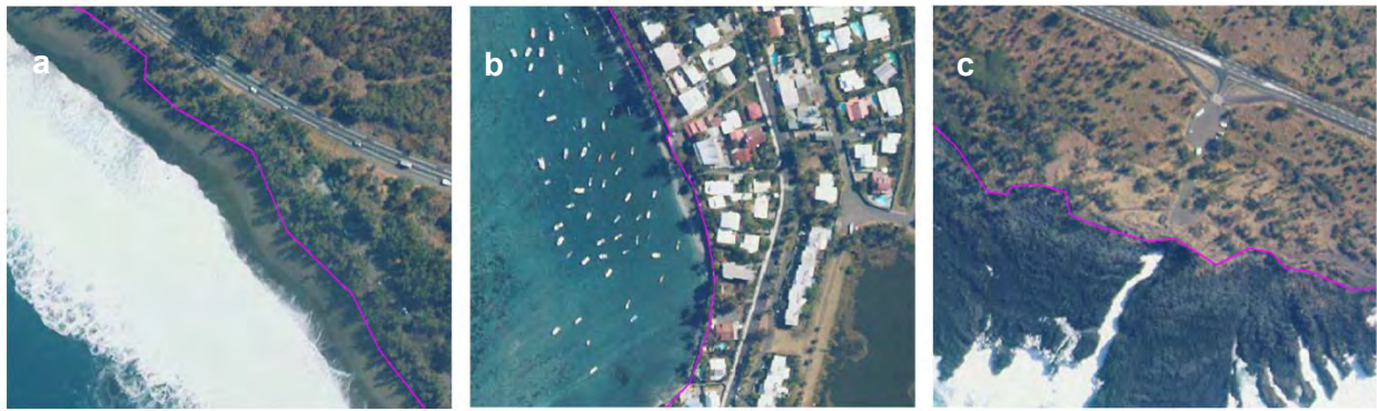
Figure 32 - Exemple de définition du trait de côte suivant les morphotypes du littoral à l'Étang-Salé : a. limite de végétation ; b. limite en pied d'aménagement ; c. limite de haut de versant
