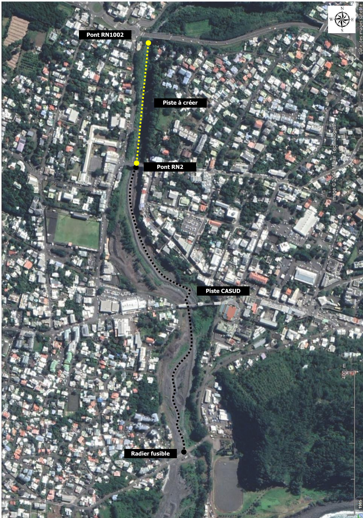
Figure 5 : Linéaire de piste provisoire de chantier à réaliser
