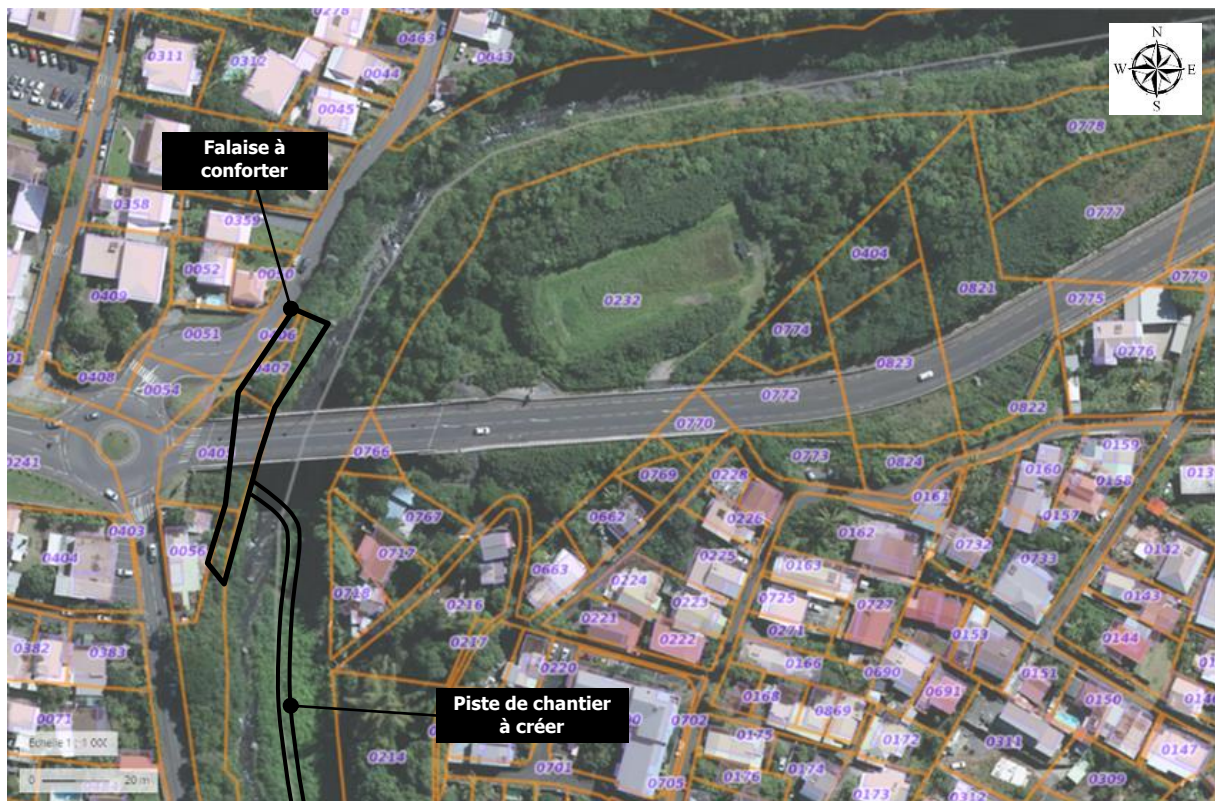
Figure 4 : Localisation détaillée des zones à conforter
