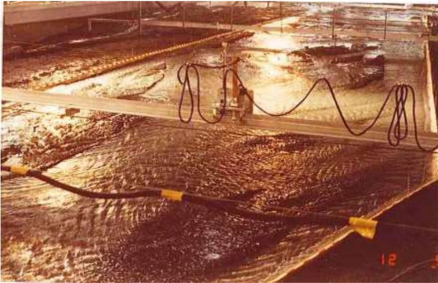
Limnodyn utilisé pour le levé automatique des profils en travers
