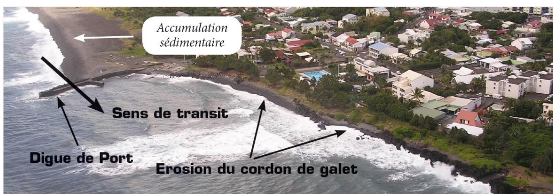
Figure 17 – Exemple de digue bloquant le transit sédimentaire à Saint-Benoît (De La Torre et al, 2012)
