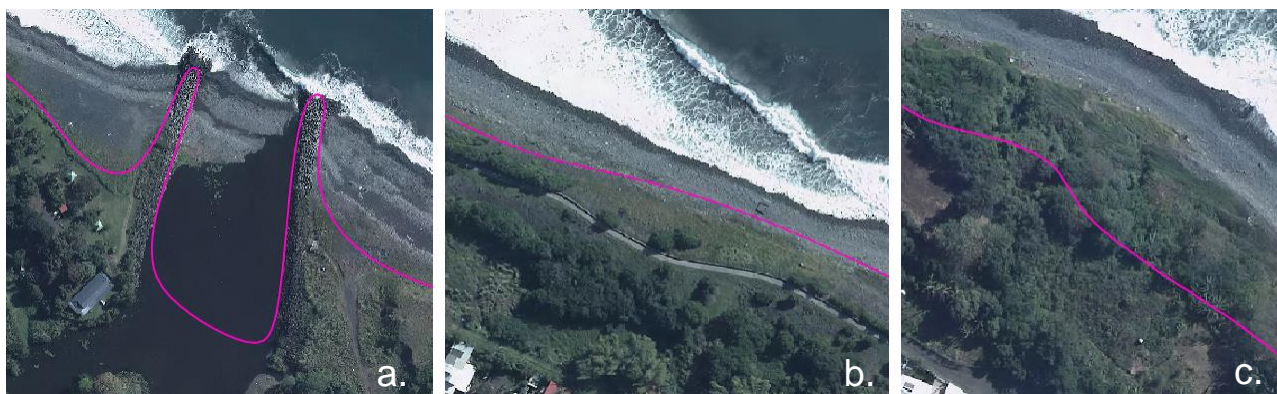
Figure 29 – Exemple de définition du trait de côte suivant les morphotypes du littoral de la côte nord-est : a. limite en pied d'aménagement (ortho 2011); b. limite de végétation (ortho 2011); c. limite de haut de versant (lidar)
