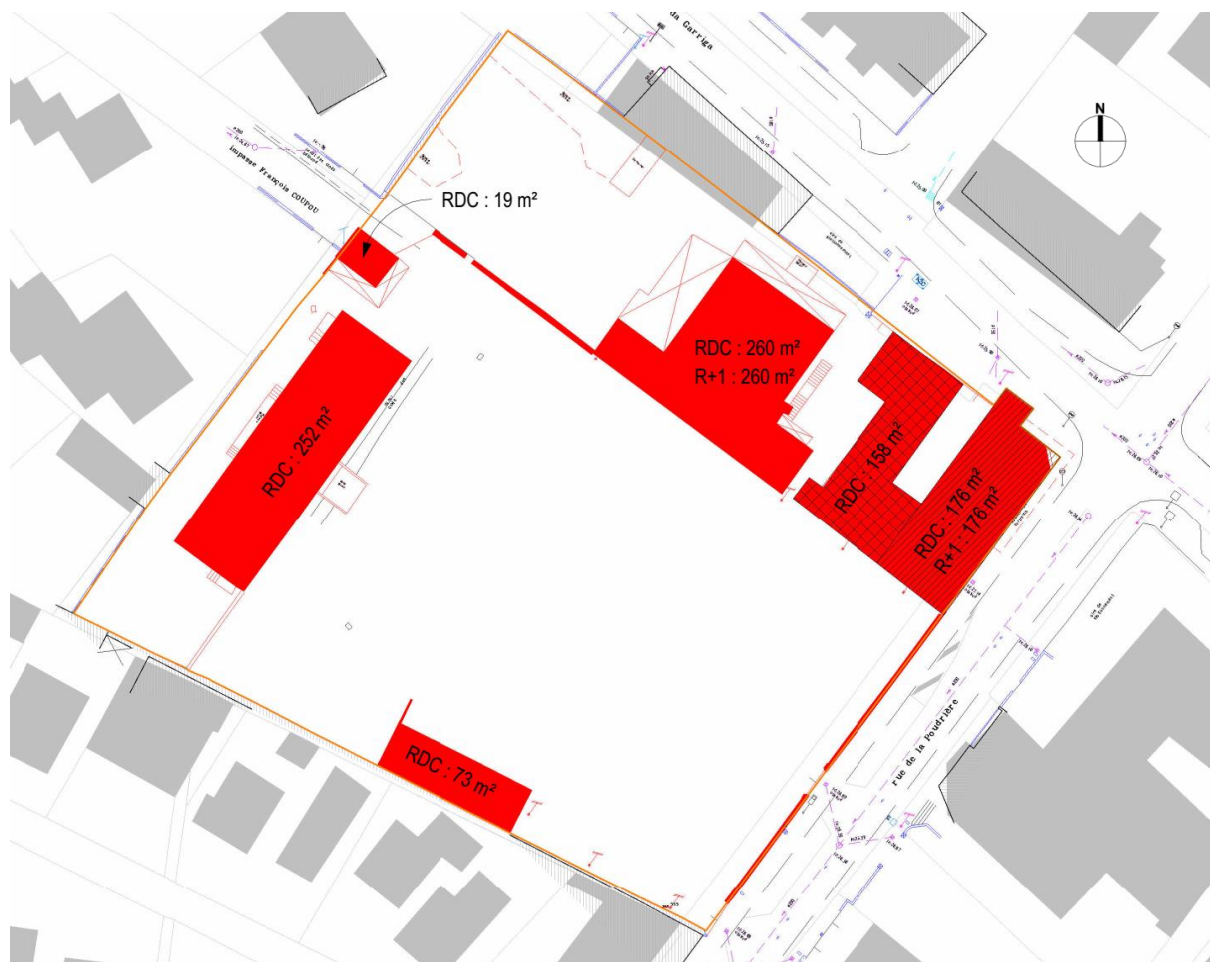
Figure 8 : Plan des démolitions
