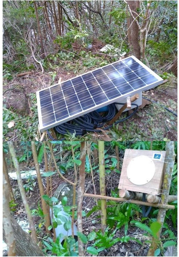
Figure 47 : Photographie du système de repasse acoustique des terriers artificiels dans la Rivière des Rempart, ©programme LIFE+ Pétrels
