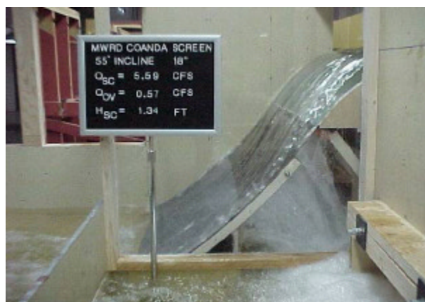
Prototypage de grille Coanda testé en laboratoire (Wahl, 2003)
