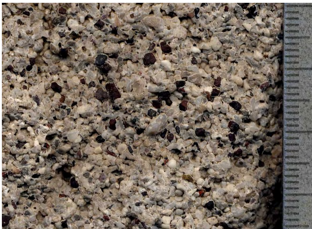
Figure 4: Sable de plage de La Réunion en cours de cimentation. Les éléments clairs correspondent à des éléments coralliens alors que les grains sombres sont de nature basaltique. Photo: Philippe Mairine.
