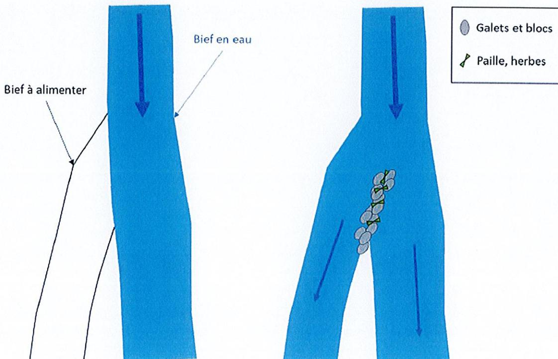
Figure 2 : Schéma de principe d'un répartiteur de débit
